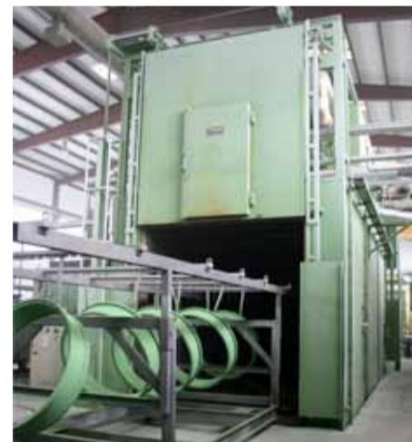
Stampi in acciaio per prodotti in PUR: Ø 1300 x 450 mm
