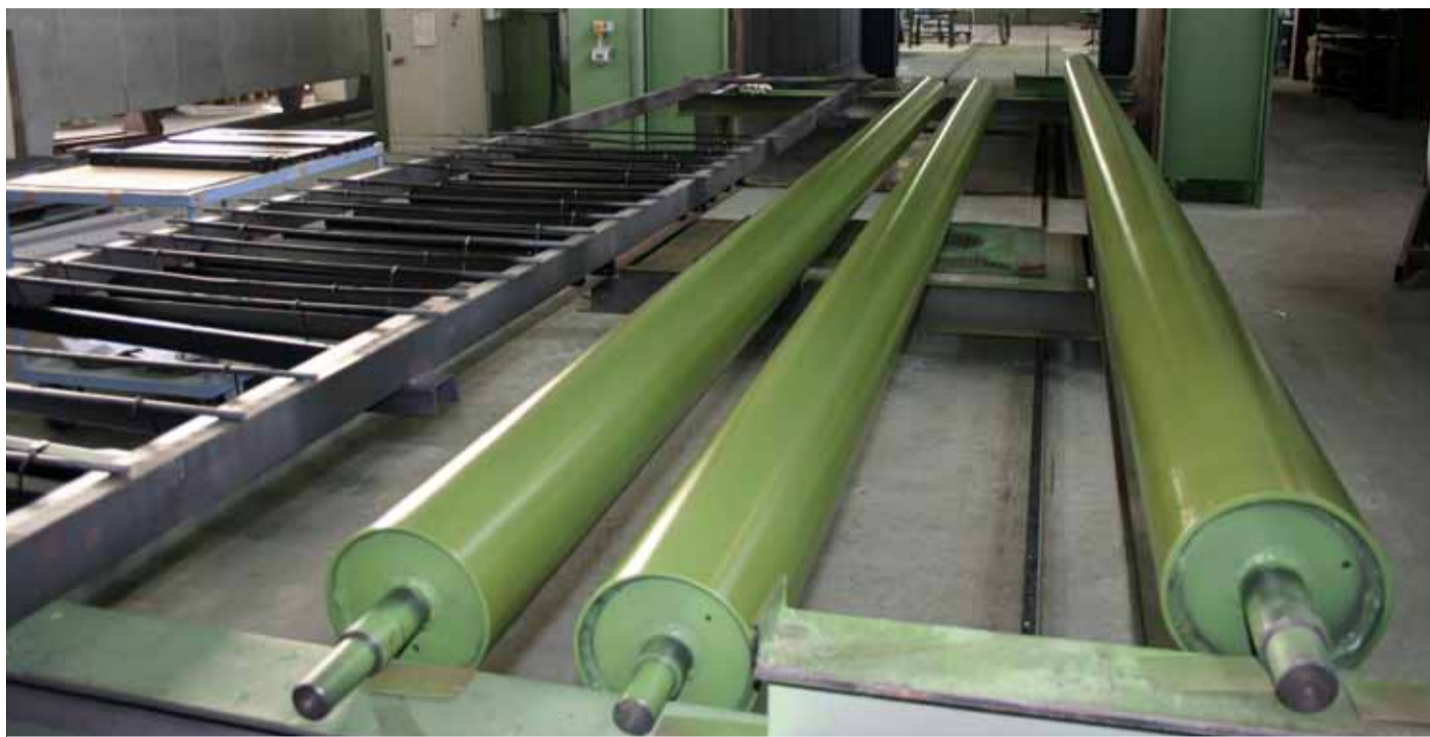
Rulli in acciaio per la produzione di plastica: Ø 300 x 7100 mm di lunghezza del corpo centrale
