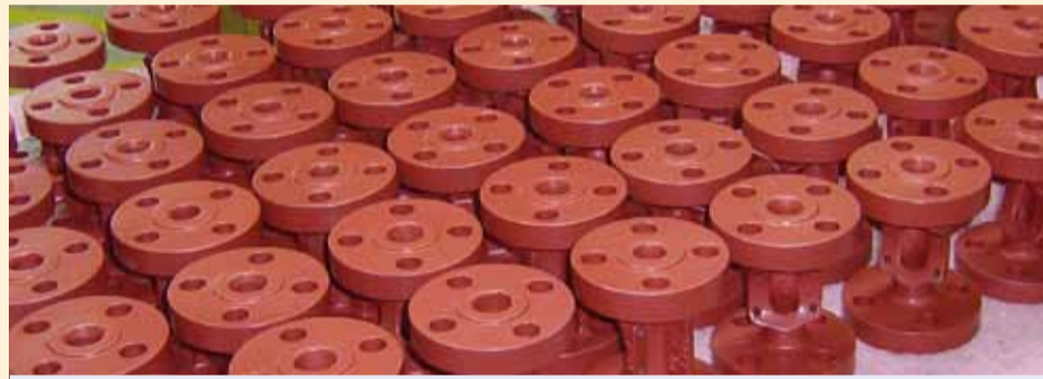
Serie di corpi valvola dotati del rivestimento MagnaCoat® per il Kazakistan
