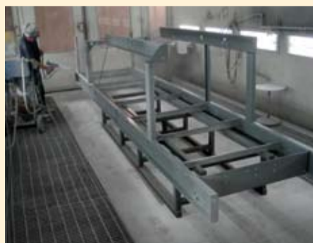
Il grande trasportatore lungo 6,4 metri in acciaio inox rivestito con Halar® ECTFE.
