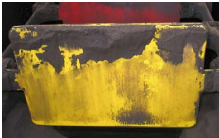
Trascinatore con depositi di carbone
