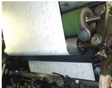
Trazione e antiaderenza per migliorare la stampa dei fogli di alluminio.
