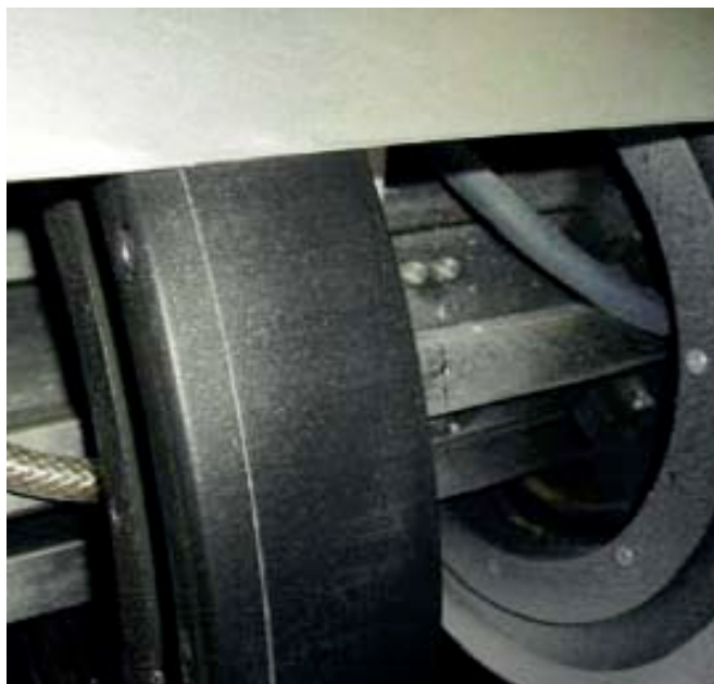
Dischi di raffreddamento con rivestimento impreglon per prevenire l'adesione, migliorare lo scorrimento a freddo e aumentare l'antiaderenza nella produzione della pellicola in PE / Cooling disks with Impreglon's coating preventing from adhesion, improving cold sliding and increasing anti-adherence in the PE film manufacture.
