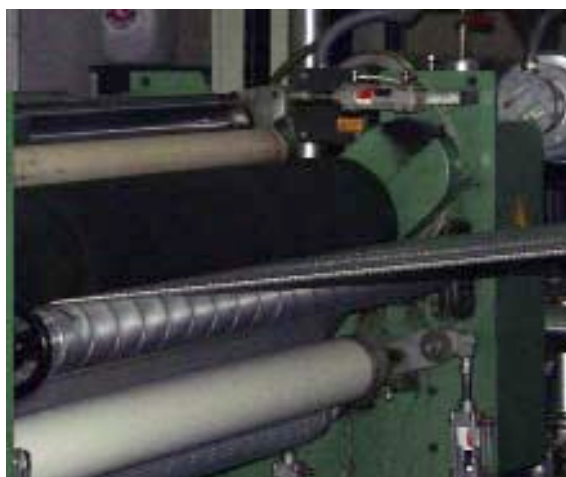
Rivestimento Impreglon per aumentare le proprietà antiaderenti e la trazione dei rulli trasportatori senza danneggiare la pellicola plastificante / Impreglon's coating improving the anti-adherent properties and conveying roller traction without damaging the coating film
