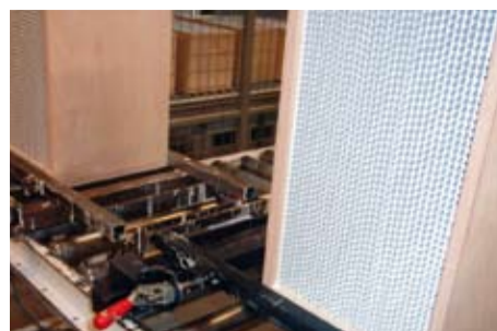
I filtri speciali vengono incollati sul telaio
